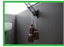
室内外で、PM2.5やシックハウス症候群の原因となる揮発性有機化合物などの化学物質の数値を調べています
